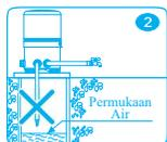
2. Hindari pengoperasian pompa dengan tidak menghisap air dalam waktu yang lama. Karena dapat memperpendek usia pemakaian pompa.
